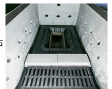
MAGNO-UF 250 - 550 kW 下込め式ストーカ炉
