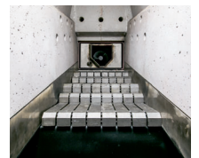
MAGNO-VR 250 - 600 kW 水平式ストーカ炉
